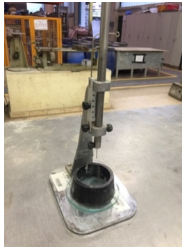
Figura 3.15 – Aparelho de Vicat munido de agulha
