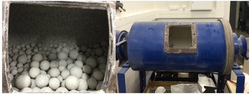
Figura 3.8 – Moinho de bolas e esferas de aço.
