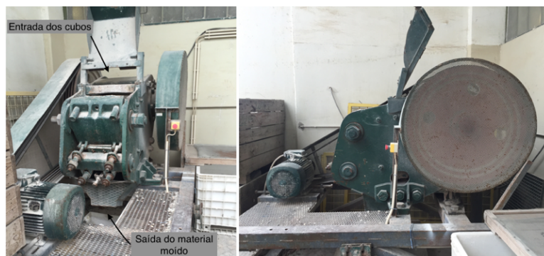
Figura 3.4 – Britadeira de maxilas usada na primeira fase de moagem
