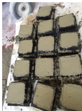
Figura 3.3 – Moldes cúbicos betonados
