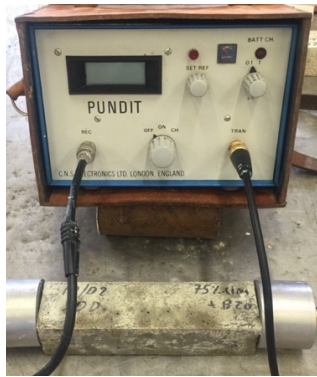
Figura 3.20 – Equipamento da marca C.N.S Electronics PUNDIT 6.
